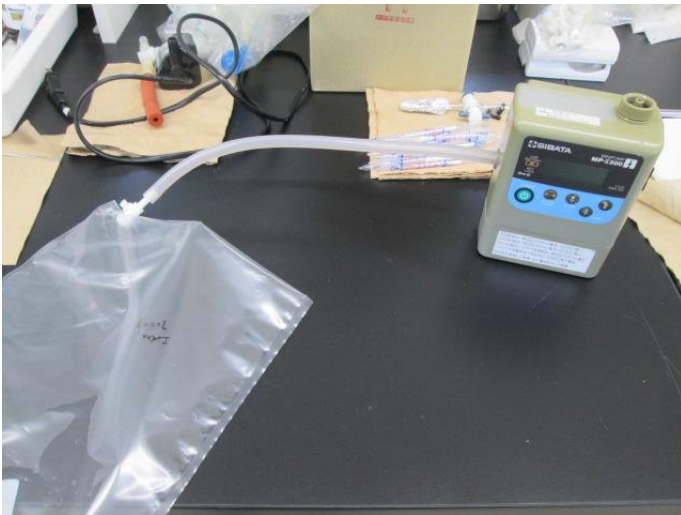
図6 ミニポンプとテドラーバッグを繋ぎ、テドラーバッグ内に空気を送る
